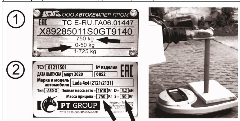
Рисунок 4. Информация о нагрузках на шильдиках: 1 - трейлерах; 2 - фаркопах. Измерение вертикальной нагрузки на шар.
