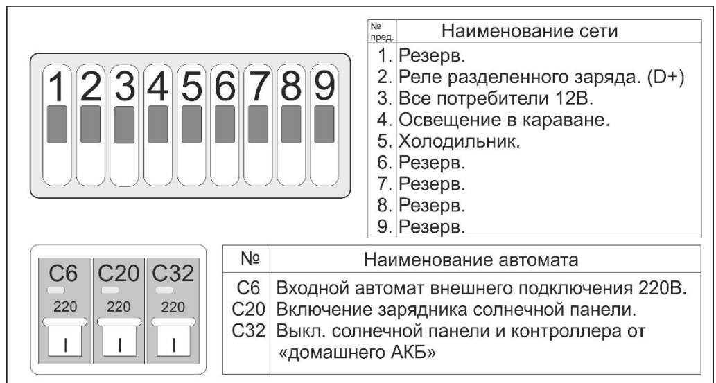
Рисунок 17. Предохранители коммутационного блока.
